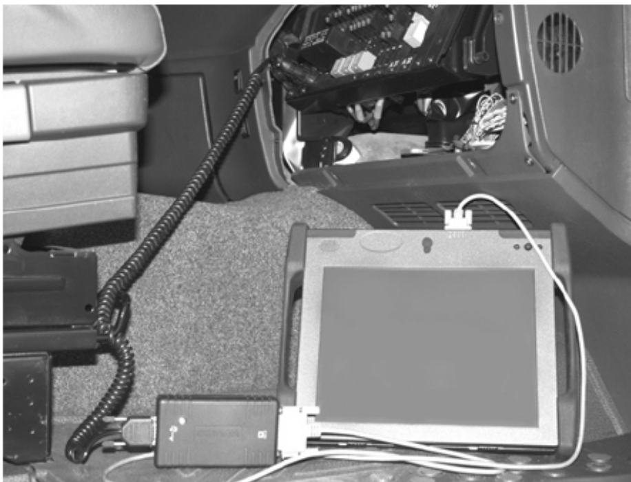
Подключение диагностического ПК к транспортному средству
