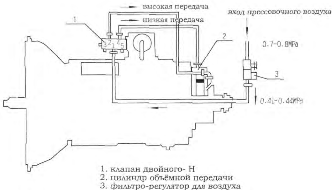
Рис.9 Схема пневматического контура переключательного органа двойного Н
